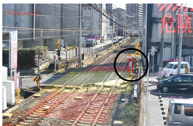
AI 画像解析装置により人を検知している様子（マル枠内の点線）
